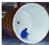
Realización de revestimientos anticorrosivos con hoja de FEP, MFA, PFA, PTFE (TEFLON®), PVDF y otros materiales para la industria química.
