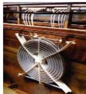
Intercambiadores de calor en PTFE (TEFLON®), PFA y FEP para el calentamiento y enfriamiento de baños corrosivos en la industria química y de galvanotecnia.
